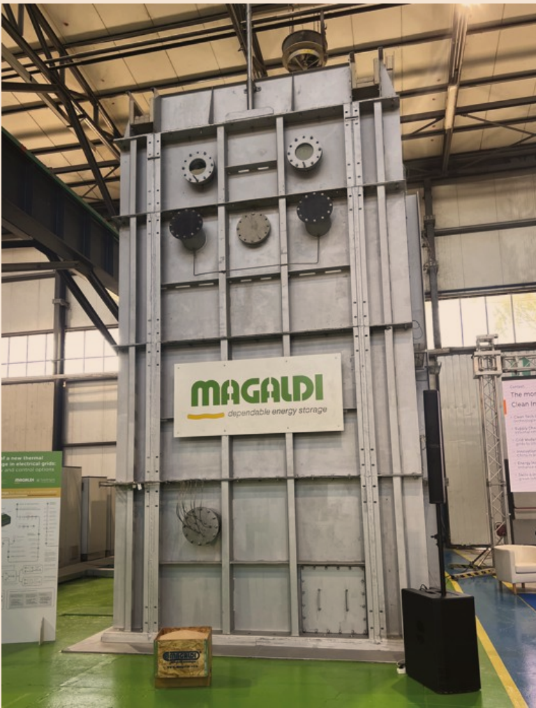
L'impianto. Riceve energia da fonti rinnovabili o dalla rete e la accumula utilizzando silicio, ovvero semplice sabbia
