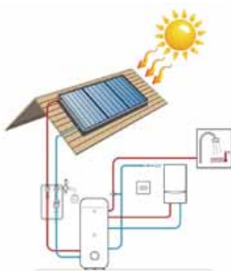
Figura 11: Schema impianto solare termico (Fonte: www.mondoenergia.net )
